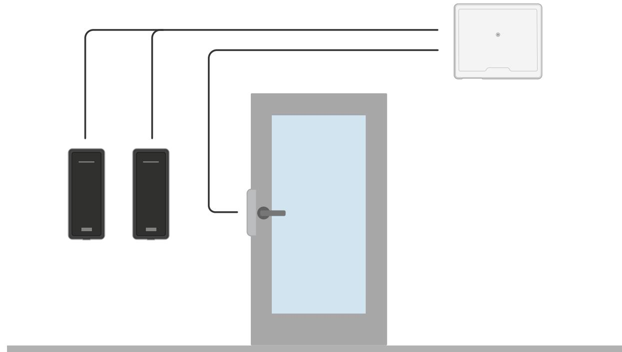
Netzwerk-Türcontroller sind mit intelligenten Funktionen ausgestattete Geräte, die einfach in Türnähe angebracht werden können. Sie können bis zu zwei Lesegeräte mit Strom versorgen und steuern.
