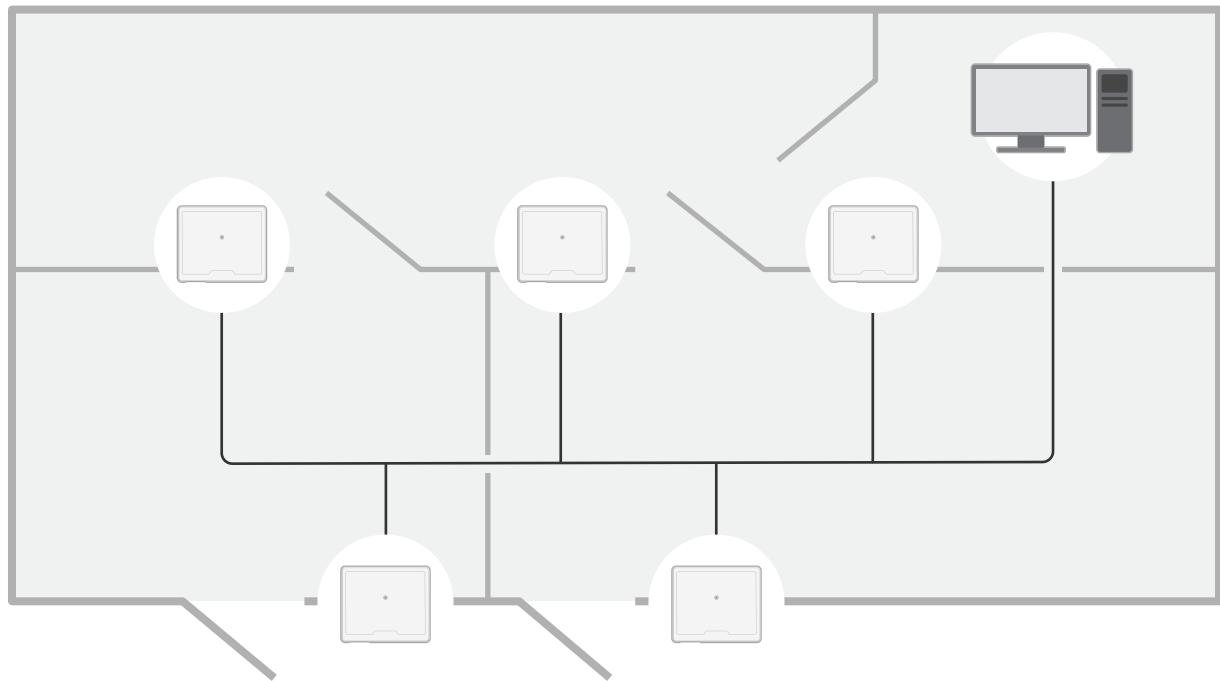
网络门禁控制器可以轻松地连接到您现有的 IP 网络并由其供电，无需专用电缆。
