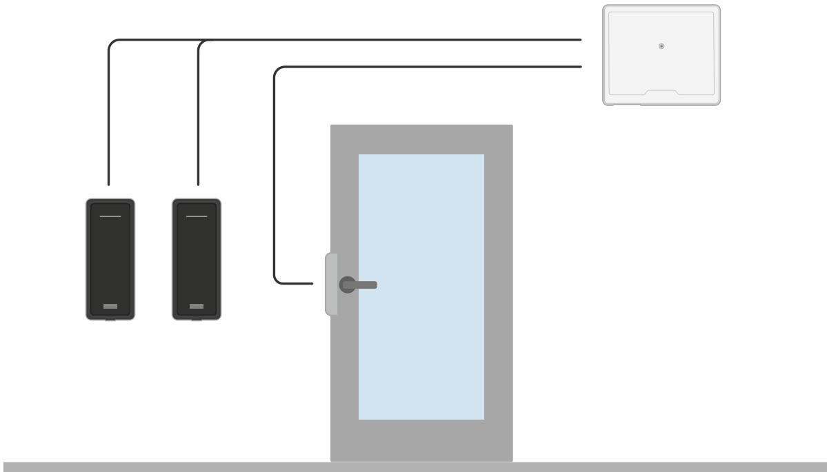
每个网络门禁控制器都是一个智能设备，可以轻松安装在靠近门的位置。它可以供电和控制高达两个读取器。
