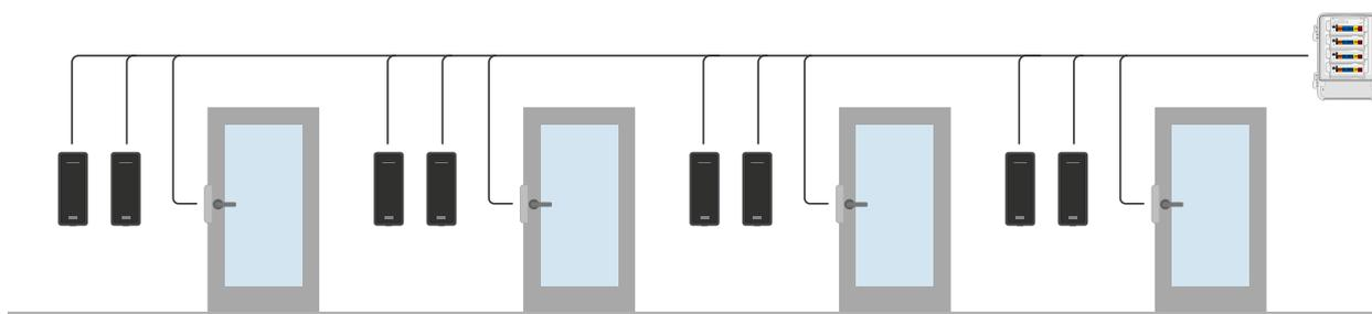
Ogni kit door controller di rete è in grado di alimentare e controllare un massimo di otto lettori.
