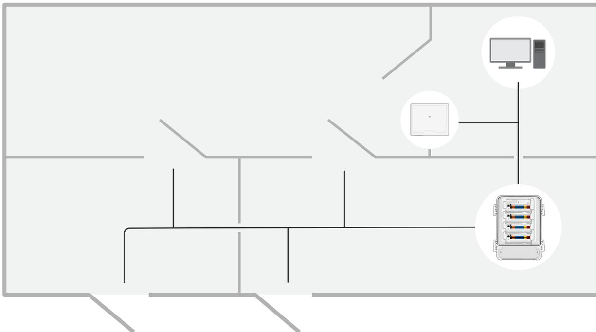
Il kit door controller di rete può essere facilmente collegato e alimentato dalla rete IP esistente senza bisogno di cablaggi speciali.
