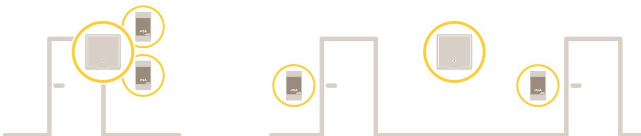
Каждый сетевой дверной контроллер представляет собой интеллектуальное устройство, которое нетрудно смонтировать рядом с дверью. Его можно использовать для питания и управления считывателями (не более двух).
