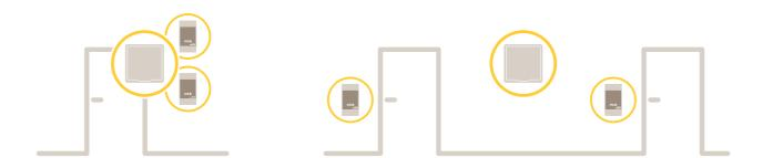
Netzwerk-Türcontroller sind mit intelligenten Funktion ausgestattete Geräte, die einfach in Türnähe angebracht werden können. Sie können bis zu zwei Lesegeräte mit Strom versorgen und steuern.
