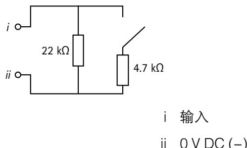
**UL：** UL并不评估监控输入是否适用于入室盗窃。仅门监控器和 REX 支持监控，使用线尾电阻器。
