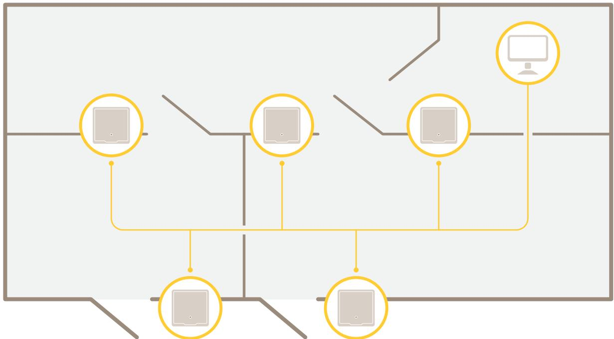
Le contrôleur de porte réseau peut facilement être connecté et alimenté par votre réseau IP existant sans câblage spécial.
