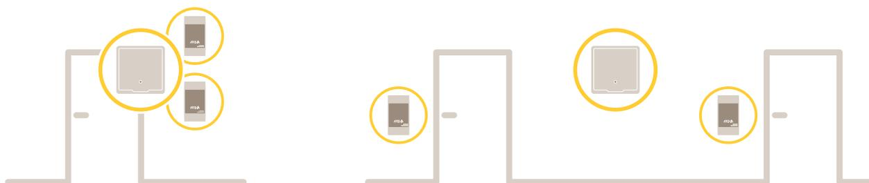
各ネットワークドアコントローラーは、ドアの近くに容易に取り付けることができるインテリジェントデバイスです。最大2つのリーダーに給電したり制御したりできます。
