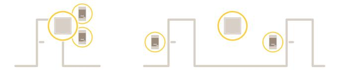
Cada controlador de porta em rede é um dispositivo inteligente que pode ser montado facilmente próximo a uma porta. Ela pode alimentar e controlar até dois leitores.
