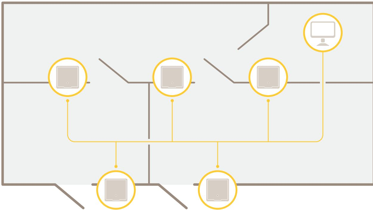
Il door controller di rete può essere facilmente collegato a e alimentato dalla rete IP esistente senza bisogno di cablaggi speciali.
