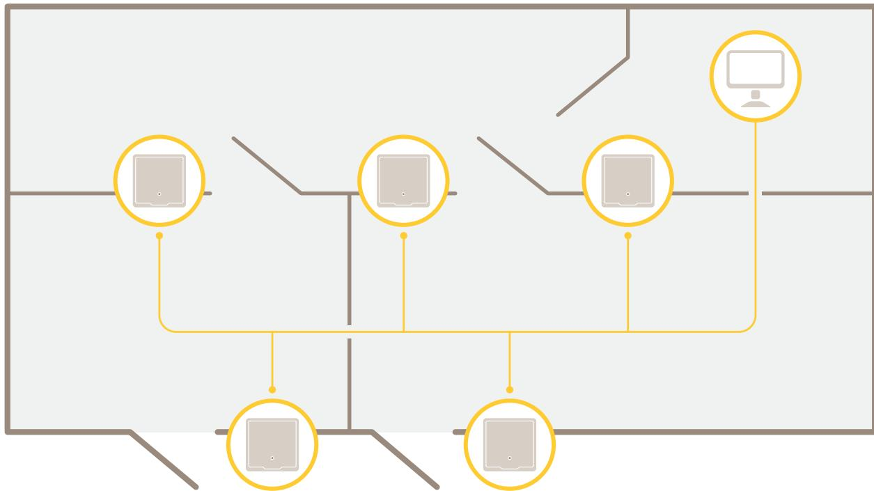
Der Netzwerk-Türcontroller kann einfach an ein bestehendes IP-Netzwerk angeschlossen und darüber mit Strom versorgt werden. Besondere Kabel sind nicht erforderlich.
