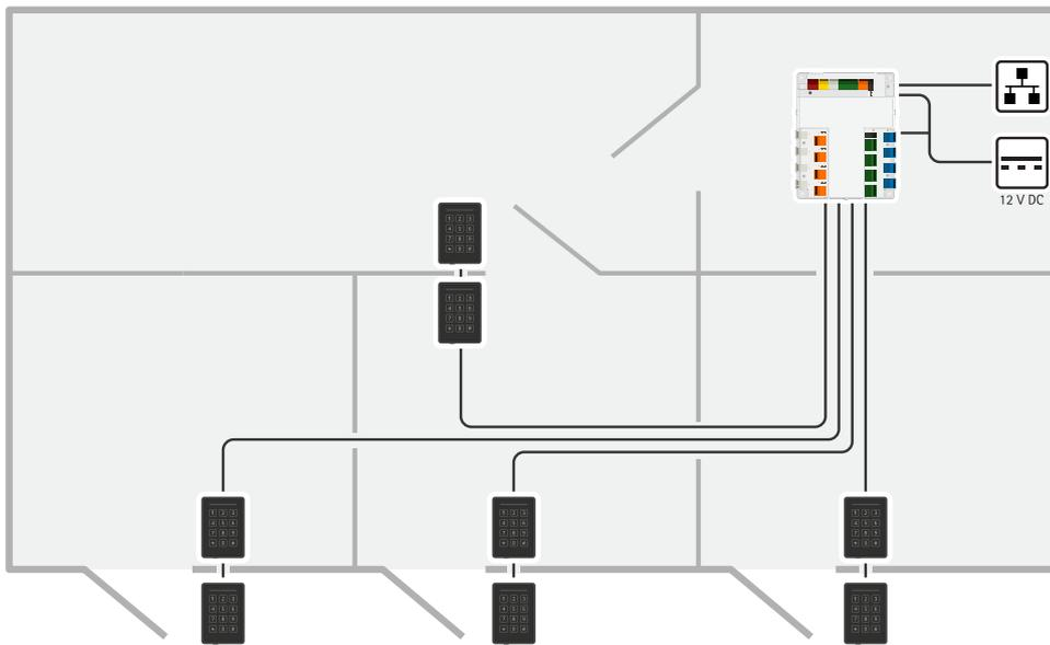
Der Netzwerk-Tür-Controller kann einfach an Ihr bestehendes IP-Netzwerk angeschlossen werden. Jeder Netzwerk-Tür-Controller kann bis zu 8 Leser und 4 Schlösser mit Strom versorgen und steuern.
