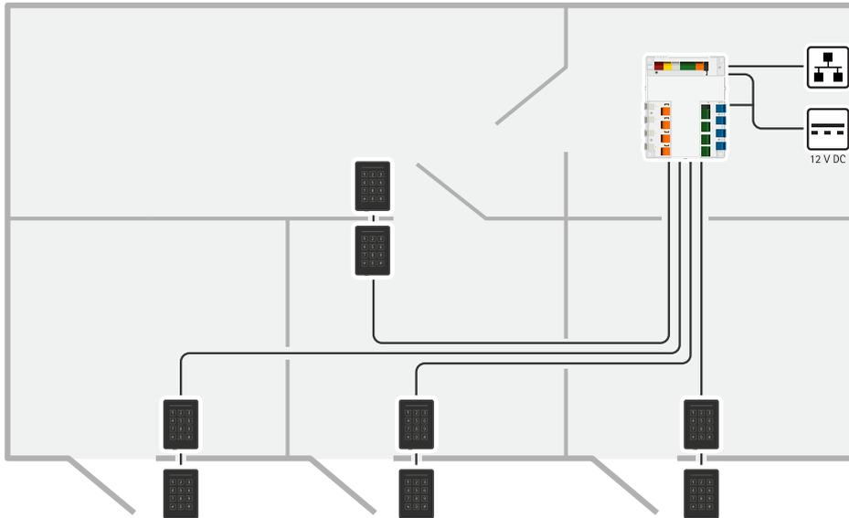
Le contrôleur de porte en réseau peut être facilement connecté à votre réseau IP existant. Chaque contrôleur de porte en réseau peut alimenter et contrôler jusqu'à 8 lecteurs.
