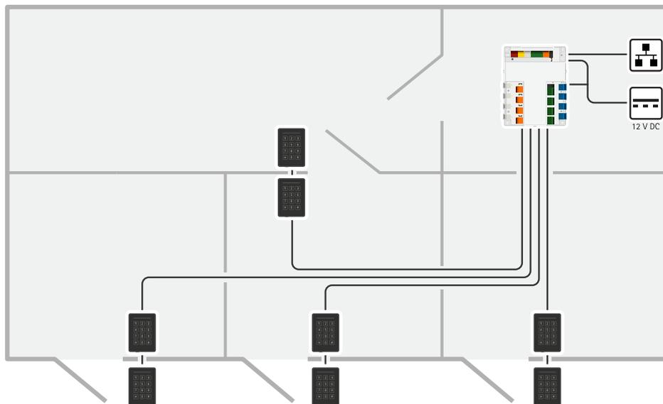
Il door controller di rete può essere facilmente collegato alla rete IP esistente. Ogni door controller di rete è in grado di alimentare e controllare un massimo di 8 lettori.
