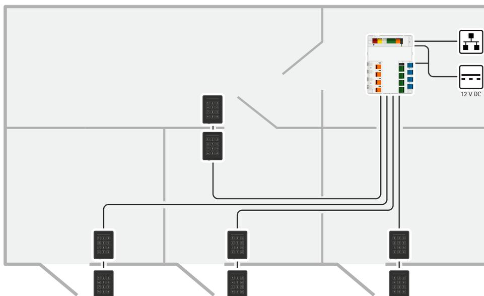
Il door controller di rete può essere facilmente collegato alla rete IP esistente. Ogni door controller di rete è in grado di alimentare e controllare un massimo di 8 lettori e 4 serrature.
