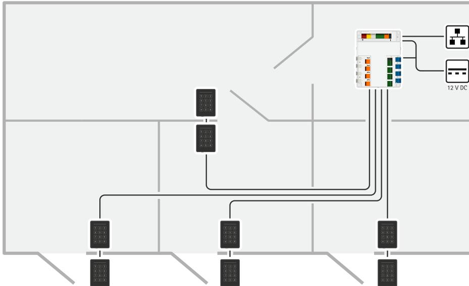
网络门禁控制器可轻松连接到现有的IP网络。每个网络门禁控制器都可以打开并控制多达8个读卡器。
