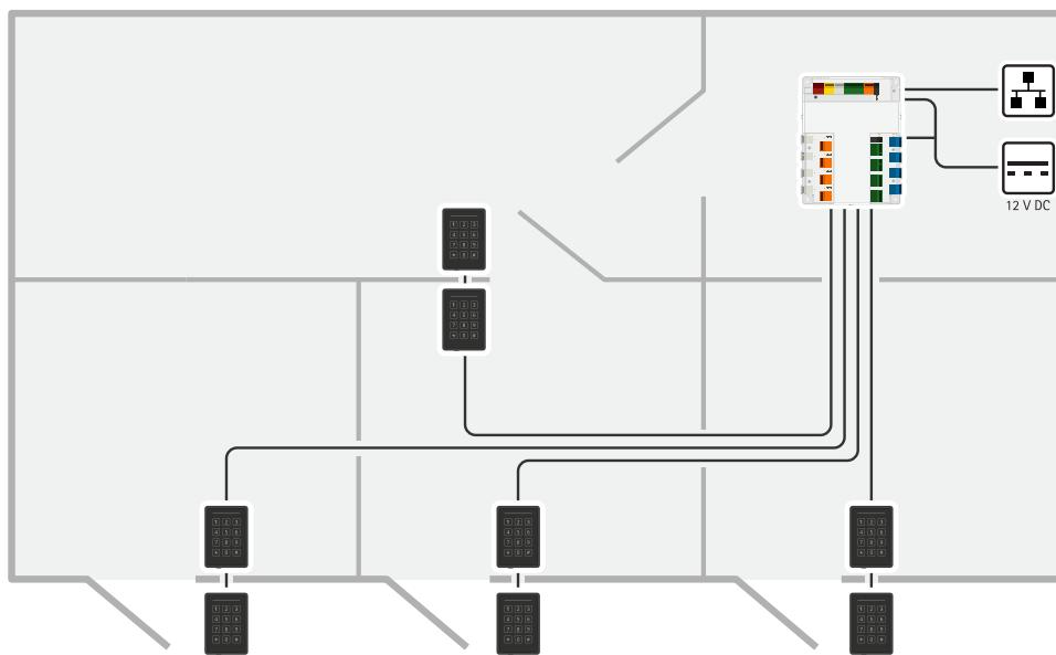
網路門禁控制器可以輕鬆連接到您現有的 IP 網路。每個網路門禁控制器最多可供電和控制 8 台讀卡機和 4 個鎖。
