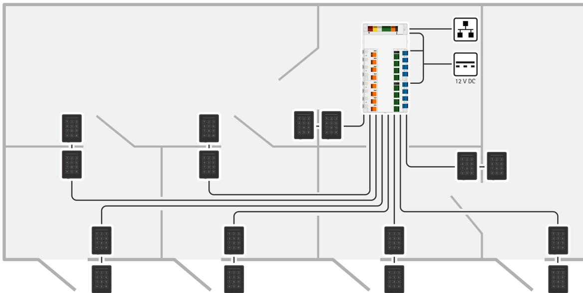
Il door controller di rete può essere facilmente collegato alla rete IP esistente. Ogni door controller di rete è in grado di alimentare e controllare un massimo di 16 lettori e 8 serrature.
