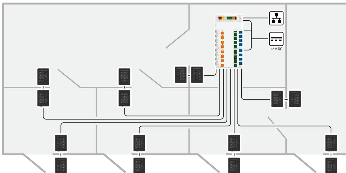
ネットワークドアコントローラーは、既存のIPネットワークに簡単に接続できます。各ネットワークドアコントローラーは最大16台のリーダーに給電し、制御できます。
