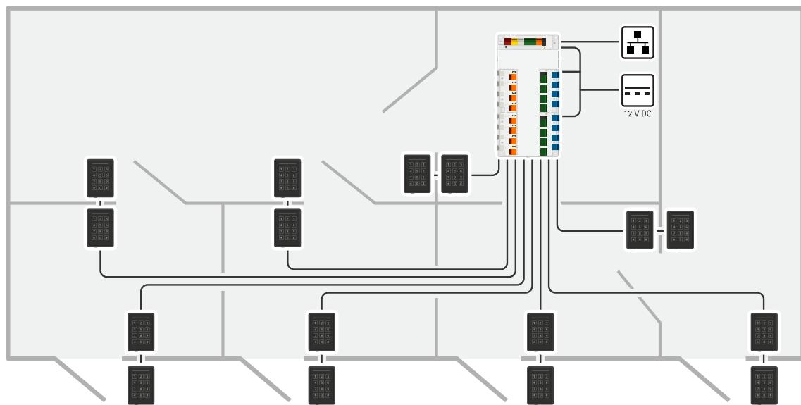
網路門禁控制器可以輕鬆連接到您現有的 IP 網路。每個網路門禁控制器最多可供電和控制 16 台讀卡機。
