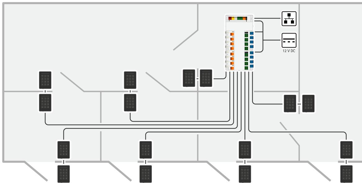
網路門禁控制器可以輕鬆連接到您現有的 IP 網路。每個網路門禁控制器最多可供電和控制 16 台讀卡機和 8 個鎖。
