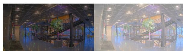
**Schärfe:** Stellen mithilfe des Schiebereglers den Randkontrast ein, um Objekte in einem Bild schärfer darzustellen. Wenn Sie die Schärfe erhöhen, kann dies zu einer höherem Bitrate und einem höheren Bedarf an Speicherplatz führen.
