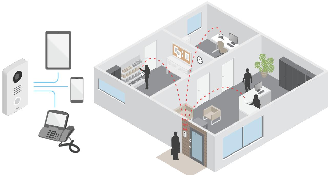
Wenn Sie die Anruftaste einer Axis Türstation drücken, wird ein Anruf für einen oder mehrere vordefinierte Empfänger initiiert. Wenn ein Empfänger antwortet, wird ein Anruf eingerichtet. Die Sprach- und Videoübertragung erfolgt über VoIP-Technologien.
