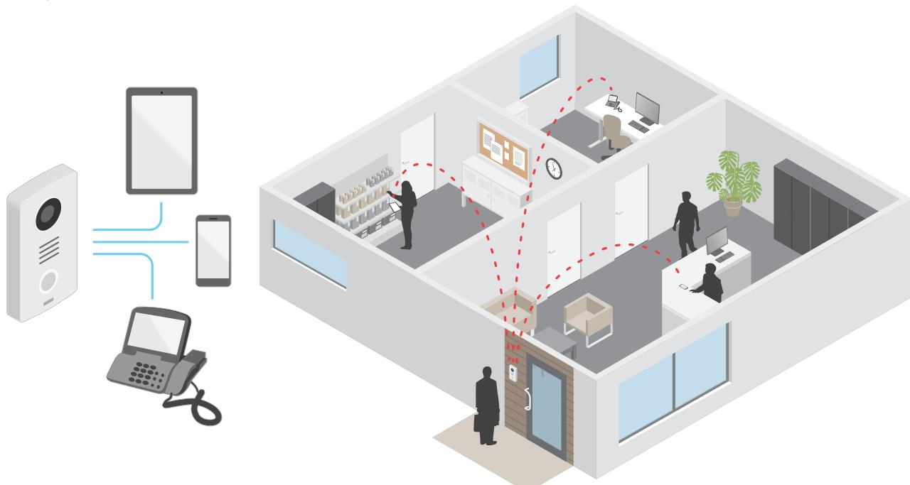
Quando si preme il pulsante di chiamata su una Axis door station, viene avviata una chiamata a uno o più destinatari predefiniti. Quando un destinatario risponde, viene stabilita una chiamata. La voce e il video vengono trasferiti tramite le tecnologie VoIP.
