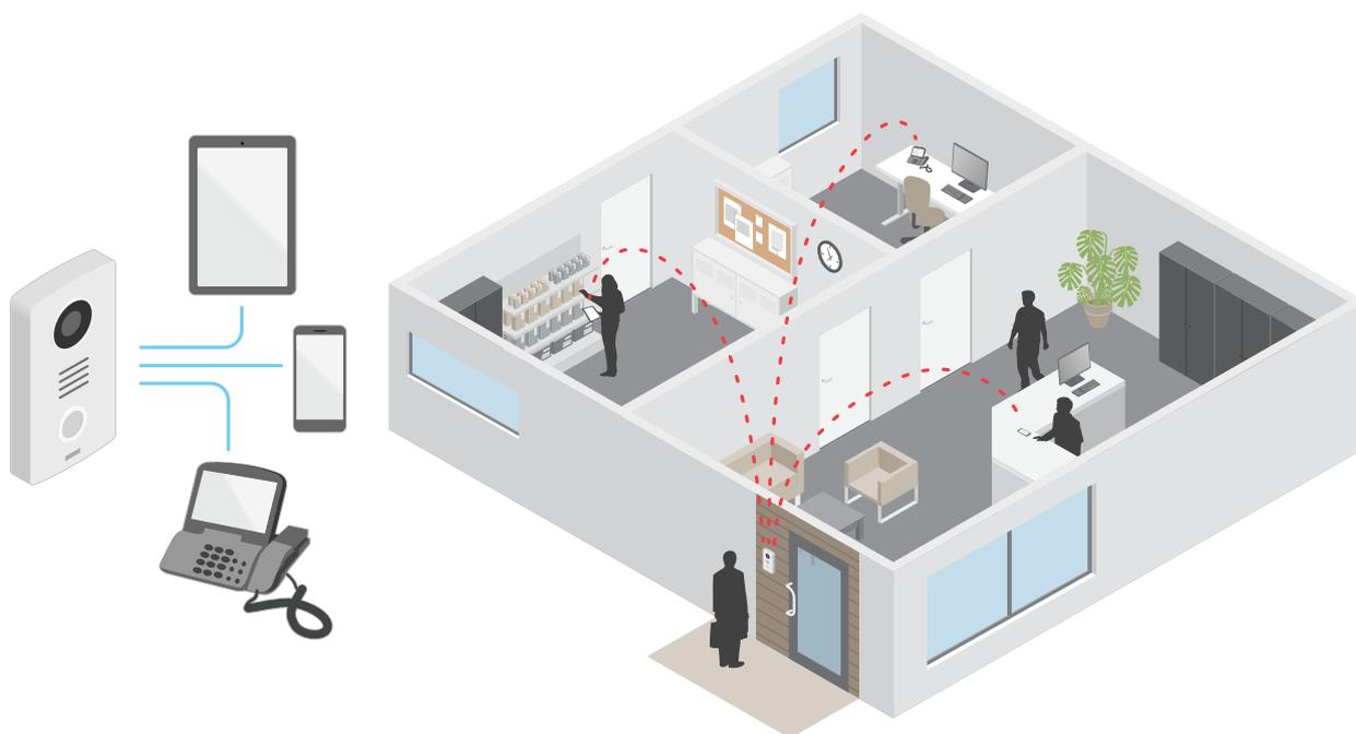
Quando si preme il pulsante di chiamata su una Axis door station, viene avviata una chiamata a uno o più destinatari predefiniti. Quando un destinatario risponde, viene stabilita una chiamata. La voce e il video vengono trasferiti tramite le tecnologie VoIP.
