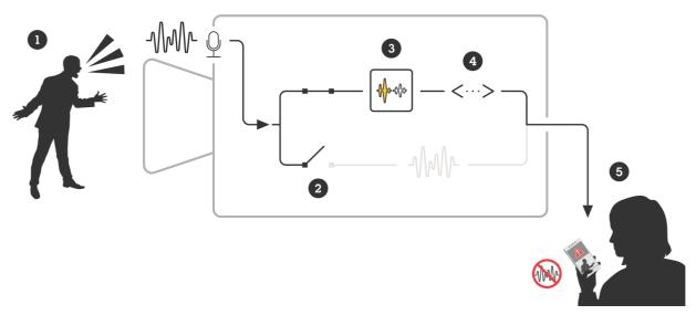
Un périphérique Axis muni d'un microphone capte le son d'un homme qui crie après quelqu'un. Le flux audio est désactivé sur cet appareil, ce qui signifie que le cri de l'homme n'est pas enregistré. AXIS Audio Analytics détecte un cri.
