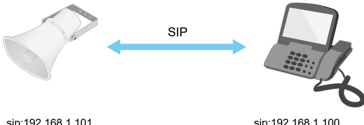
ピアツーピアSIP設定を使用して、同じネットワーク上の音声デバイスを呼び出すように、SIP対応電話を設定することができます。
