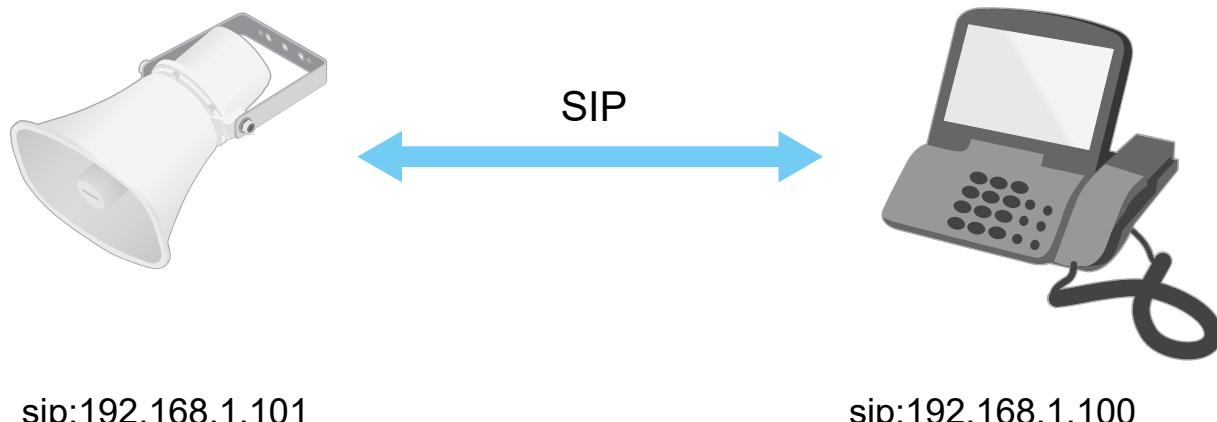
Puede configurar un teléfono habilitado para SIP para llamar a un dispositivo de audio en la misma red mediante una configuración de SIP de punto a punto.
