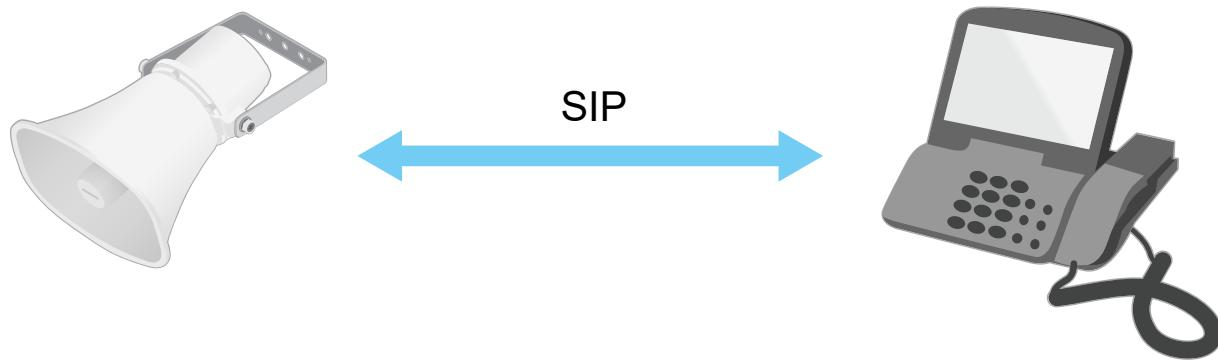
Também é possível configurar um telefone compatível com SIP para chamar um dispositivo de áudio na mesma rede usando uma configuração de SIP ponto a ponto.
