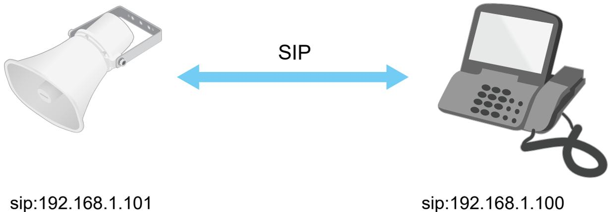
您可以使用點對點 SIP 設定來設定已啟用 SIP 的電話撥話給相同網路上的音訊設備。
