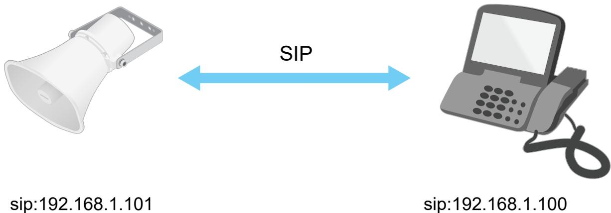
Também é possível configurar um telefone compatível com SIP para chamar um dispositivo de áudio na mesma rede usando uma configuração de SIP ponto a ponto.
