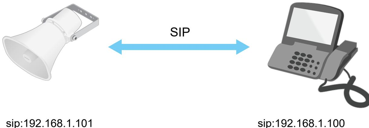
Sie können ein SIP-fähiges Telefon so einrichten, dass ein Audiogerät im selben Netzwerk über ein Peer-to-Peer-SIP-Setup angerufen wird.
