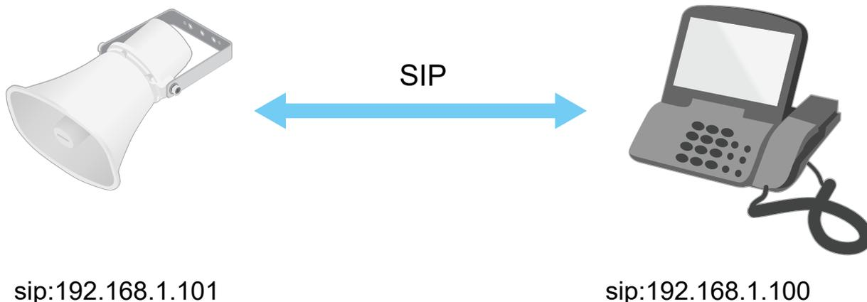
È possibile configurare un telefono abilitato SIP per chiamare un dispositivo audio sulla stessa rete utilizzando un'impostazione SIP peer-to-peer.
