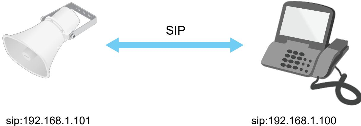
您可以安装一部已启用 SIP 的电话来呼叫同一网络上采用点对点 SIP 设置的音频设备。
