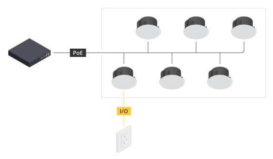
Beispiel: Der AXIS C8310 Volume Controller ist an ein Hostgerät angeschlossen, das wiederum mit dem Netzwerk verbunden ist. Das Hostgerät gehört zu einer physischen Zone.
