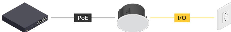
Beispiel: Der AXIS C8310 Volume Controller ist an ein Hostgerät angeschlossen, das wiederum mit dem Netzwerk verbunden ist.
