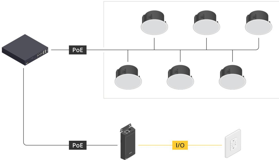
*Beispiel: Der AXIS C8310 Volume Controller ist an ein Hostgerät angeschlossen, das wiederum mit dem Netzwerk verbunden ist. Das System enthält mehrere Lautsprecher in einer physischen Zone, das Hostgerät gehört jedoch keiner physischen Zone an.*
