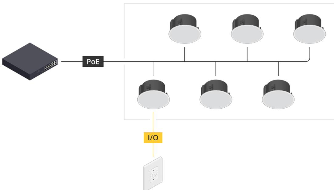
Ejemplo: Controlador de volumen AXIS C8310 conectado a un dispositivo host, que a su vez está conectado a la red. El dispositivo host pertenece a una zona física.
