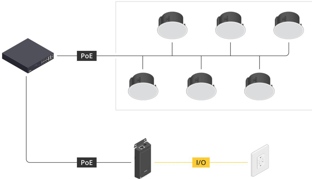
*Ejemplo: Controlador de volumen AXIS C8310 conectado a un dispositivo host, que a su vez está conectado a la red. El sistema contiene varios altavoces en una zona física, pero el dispositivo host no pertenece a ninguna zona física.*
