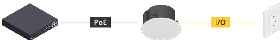
Exemple : AXIS C8310 Volume Controller connecté à un périphérique hôte, lui-même connecté au réseau.
