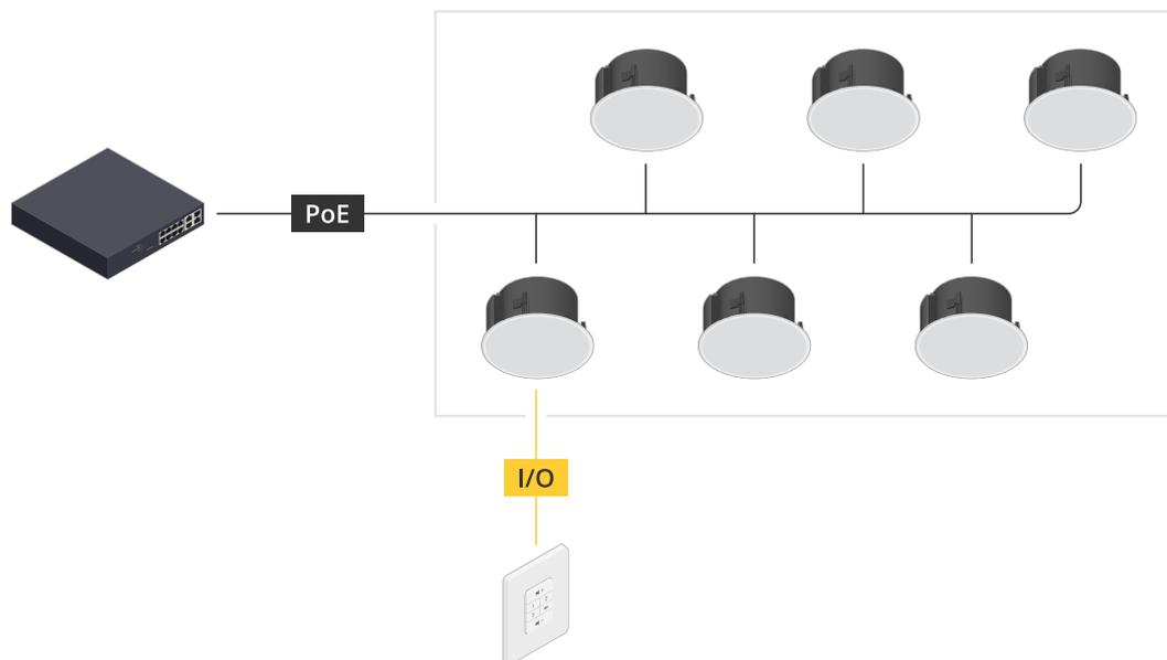
*Esempio: AXIS C8310 Volume Controller collegato a un dispositivo host a sua volta connesso alla rete. Il dispositivo host appartiene a una zona fisica.*
