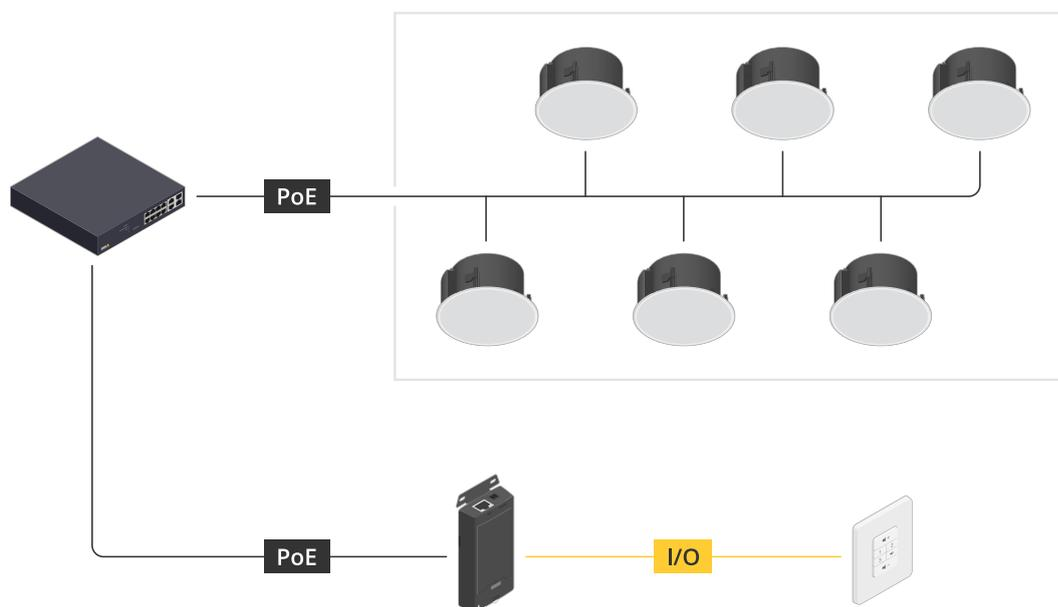
*Esempio: AXIS C8310 Volume Controller collegato a un dispositivo host a sua volta connesso alla rete. Il sistema contiene molteplici altoparlanti in una zona fisica, tuttavia il dispositivo host non appartiene ad alcuna zona fisica.*
