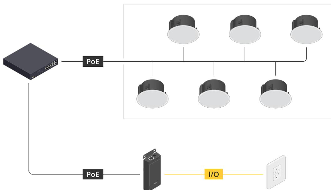
示例：AXIS C8310 Volume Controller 连接到主机设备，主机设备又连接到网络。系统在一个物理区域中包含多个扬声器，但主机设备不属于任一物理区域。
