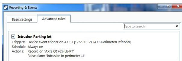
*L'esempio mostra una regola AXIS Camera Station che attivi due azioni quando si verifica un'intrusione.*
