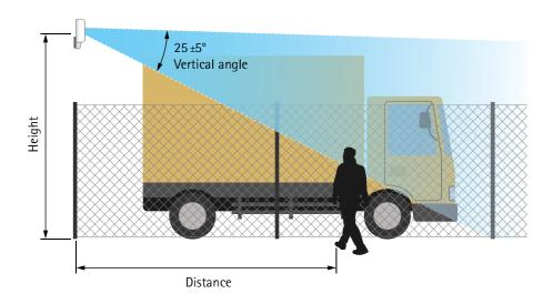
以下表格显示了在侦测某个正在行走的 1.8 米 (6 英尺) 高的人时,不同安装高度处的侦测器的侦测范围。
