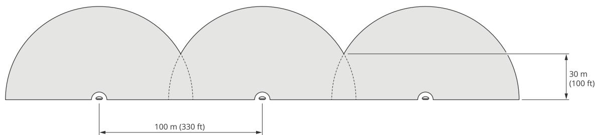
同じ共存ゾーンに3台以上のレーダーを設置した場合の干渉を避けるには、装置インターフェースで隣接するレーダーの数を設定します。さらに、4台以上のレーダーを設置する場合は、各レーダーをグループに追加します。
