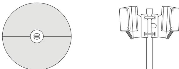
Você pode usar a saída PoE de um radar para alimentar o segundo radar, mas não é possível conectar um terceiro radar dessa forma.
