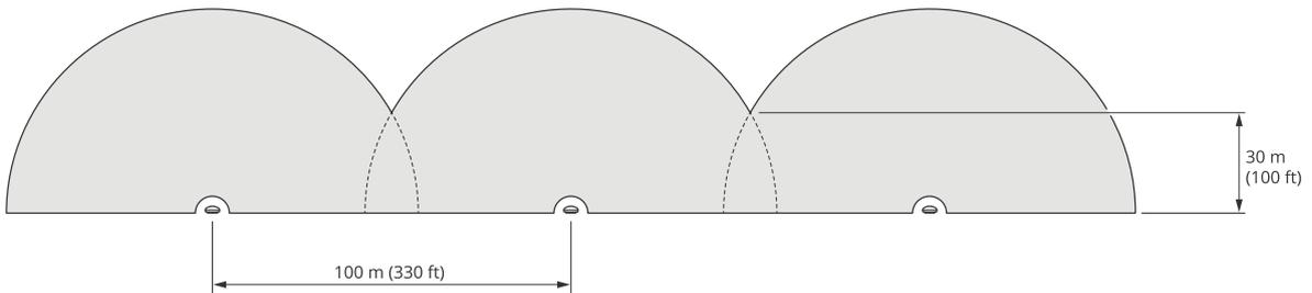
Para evitar interferências ao montar mais de dois radares na mesma zona de coexistência, defina o número de radares vizinhos na interface do dispositivo. Além disso, ao montar mais de três radares, adicione cada radar a um grupo.
