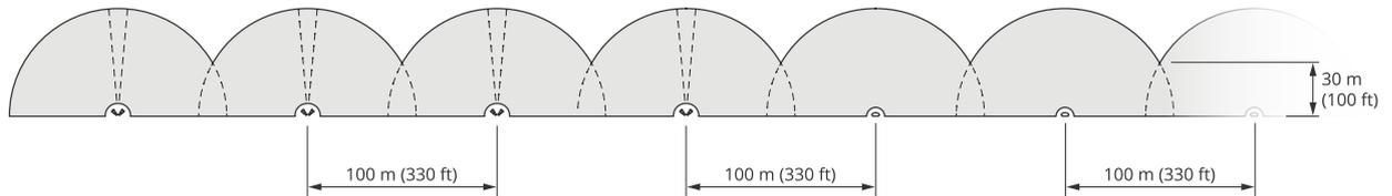
Quatro pares de AXIS D2210-VE e vários AXIS D2110-VE Security Radars montados com um espaçamento de 100 m (330 ft) entre eles.
