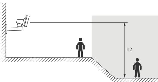
Se a superfície na área de interesse for desnivelada, adicione a altura média (neste caso  $(h_1 + h_2)/2$ ) ao configurar o radar.
