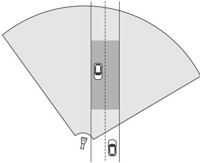
Para medir velocidades altas com precisão, posicione o radar dentro de uma distância lateral de 10 m (32 ft) em relação aos veículos. Para obter mais informações sobre o alcance da detecção e a precisão da velocidade, consulte *Alcance da detecção na estrada na página 9*.
