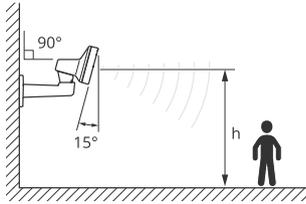
Você pode adicionar uma sobreposição à visualização ao vivo do radar que mostra o ângulo de inclinação do radar. Para obter instruções, consulte *Mostrar uma sobreposição de texto com o ângulo de inclinação do radar na página 21*.
