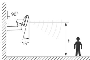
Puede agregar una superposición en la visualización en directo del radar que muestre el ángulo vertical del radar. Para obtener instrucciones, consulte
