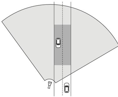
Para medir altas velocidades con precisión, coloque el radar a una distancia lateral de 10 m de los vehículos. Para obtener más información sobre el rango de detección y la precisión de la velocidad, consulte .
