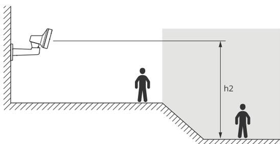
Si la superficie del área de interés no es uniforme, agregue la altura media (en este caso  $(h_1 + h_2) / 2$ ) cuando configure el radar.
