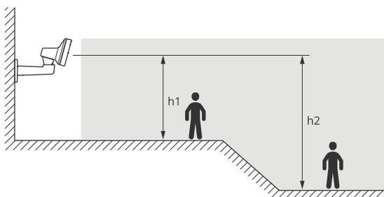
Ajustar de la altura de montaje:
