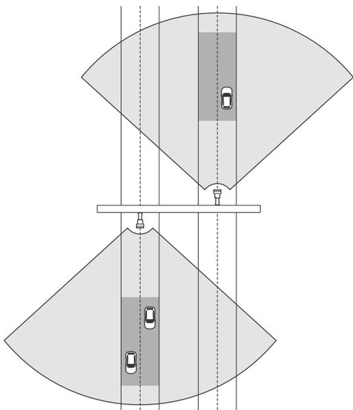
Pour mesurer précisément les vitesses élevées, positionnez le radar à une distance latérale de 10 m (32 pi) des véhicules. Pour plus d'informations sur la portée de détection et la précision de la vitesse, consultez .
