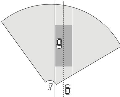
Pour mesurer précisément les vitesses élevées, positionnez le radar à une distance latérale de 10 m (32 pi) des véhicules. Pour plus d'informations sur la portée de détection et la précision de la vitesse, consultez .
