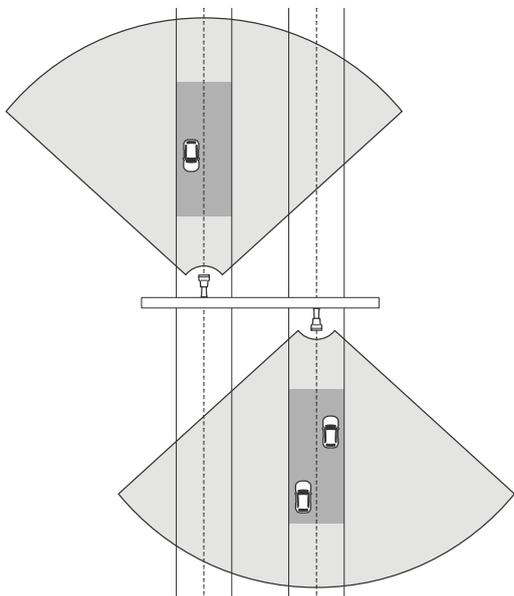
Le même type d'installation est possible si vous souhaitez surveiller des véhicules qui s'éloignent du radar, au lieu de rouler vers lui.
