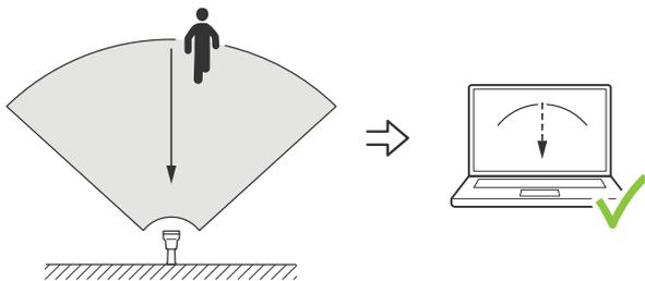
**Vérifiez que le symbole et le sens du déplacement sont corrects lorsque le radar est approché sur le côté**
