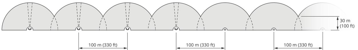
4組のAXIS D2210-VEと複数のAXIS D2110-VE Security Radarが100 m (330 ft)の間隔で取り付けられている。
