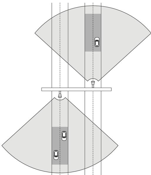
高速走行を正確に測定するには、レーダーを車両から横方向で10 m以内に設置してください。検知範囲と速度精度の詳細については、を参照してください。
