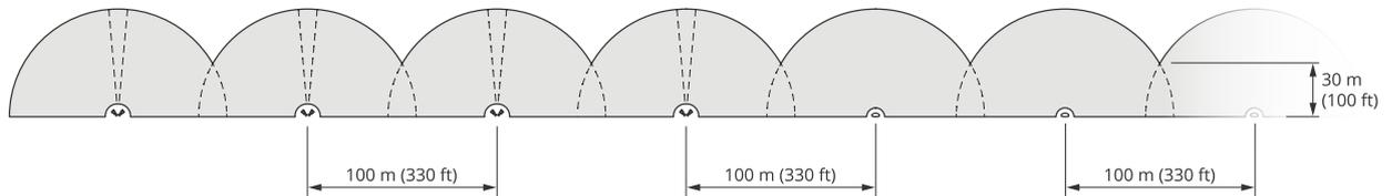
4組のAXIS D2210-VEと複数のAXIS D2110-VE Security Radarが横に並べて取り付けられている。
