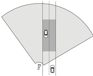
高速走行を正確に測定するには、レーダーを車両から横方向で10 m以内に設置してください。検知範囲と速度精度の詳細については、を参照してください。
