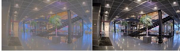
**Brightness (Brilho):** use o controle deslizante para ajustar a intensidade de luz. Isso pode facilitar a visualização dos objetos. O brilho é aplicado após a captura da imagem e não afeta as informações existentes na imagem. Para obter mais detalhes de uma área escura, geralmente é melhor aumentar o ganho ou o tempo de exposição.
