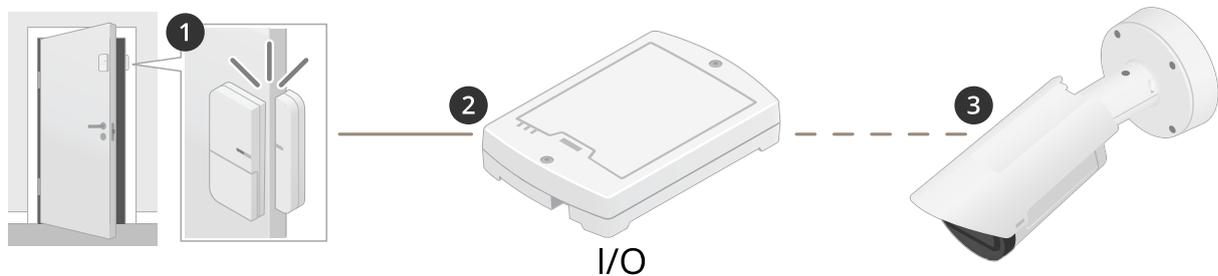
Dans ce cas, la caméra n'est pas située à proximité de la porte. Le capteur de porte est connecté par câble à un relais d'E/S, qui est connecté à la caméra sur le réseau.
