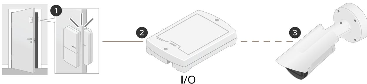
Dans ce cas, la caméra n'est pas située à proximité de la porte. Le capteur de porte est connecté par câble à un relais d'E/S, qui est connecté à la caméra sur le réseau.
