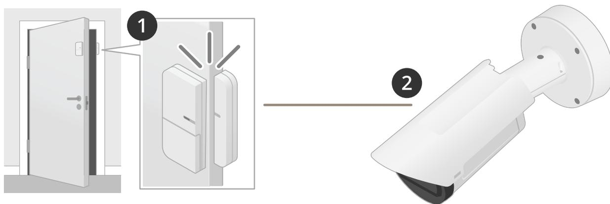
Dans ce cas, la caméra se trouve à proximité de la porte et le capteur de porte est connecté par câble au port d'E/S de la caméra.
